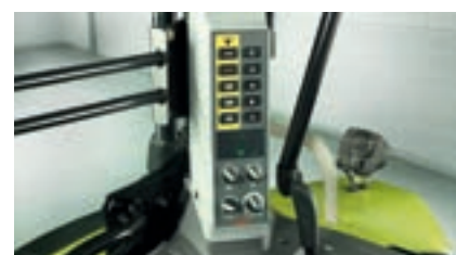
Présélection des régimes de prise de force et relevage arrière électronique installés sur le montant arrière droit de la cabine
