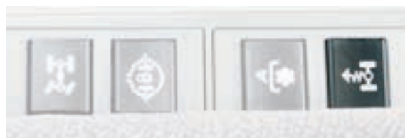
Activation de la suspension du pont avant
