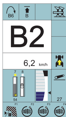
Sélection intelligente du rapport sur l'affichage du montant droit de la version CIS
