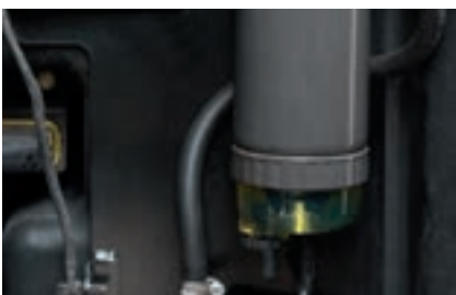
Le préfiltre à carburant est directement accessible près du marchepied d'accès à la cabine.
