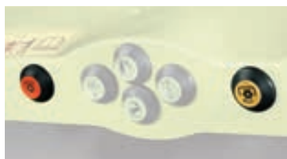
Commande extérieure de la prise de force arrière
