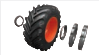
Différentes possibilités de lestage pour les roues
