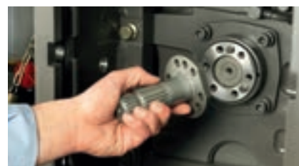
Embout de prise de force facilement interchangeable
