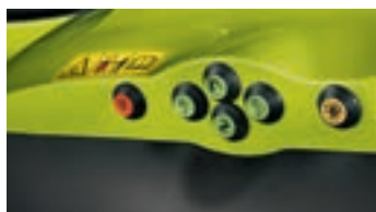
Commandes extérieures pour le relevage arrière, la prise de force et un distributeur au choix (CEBIS uniquement)
