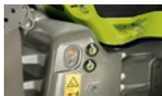
Commande extérieure du relevage avant et d'un distributeur (CEBIS uniquement)
